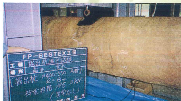
掘出しぐいの静曲げ試験
